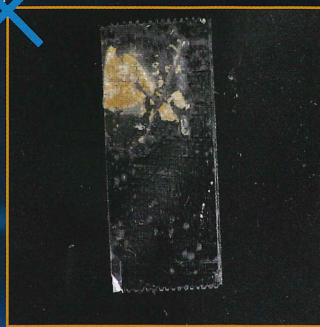
劣化着色層剥離 塗装不可
