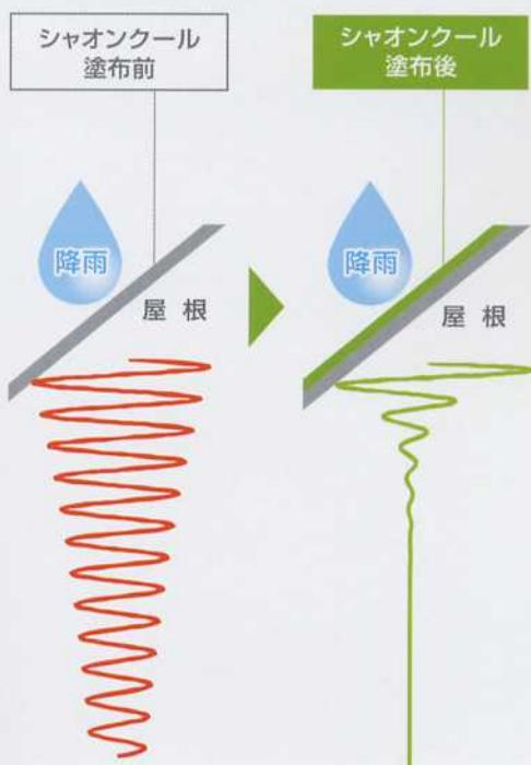
・雨滴により、屋根が振動し騒音を発します。
