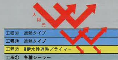
遮熱タイプ仕様にIP水性遮熱プライマーの工程をプラスすることにより、さらに約10~15%の赤外線を反射し、遮熱効果を高めます。
