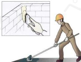
**12** 【完成】12時間以上(23°C)乾燥させます。(エコトップ遮熱が完全に乾く前に養生を取り除いてください。)
