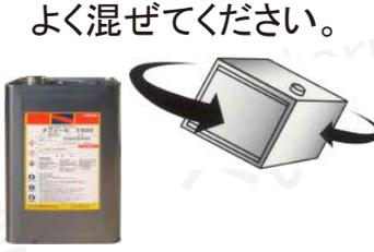
**5** タフシール100に対してパーメックを約1~2%割合で配合し均一になるように攪拌機でよくかき混ぜます。
