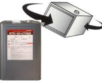
**14** タフシールトップ1000を100%に対してパーメックを約1~2%配合し均一になるよう攪拌機でよくかき混ぜます。
