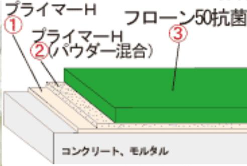
FD-P1平滑工法総合膜厚1.1mm
